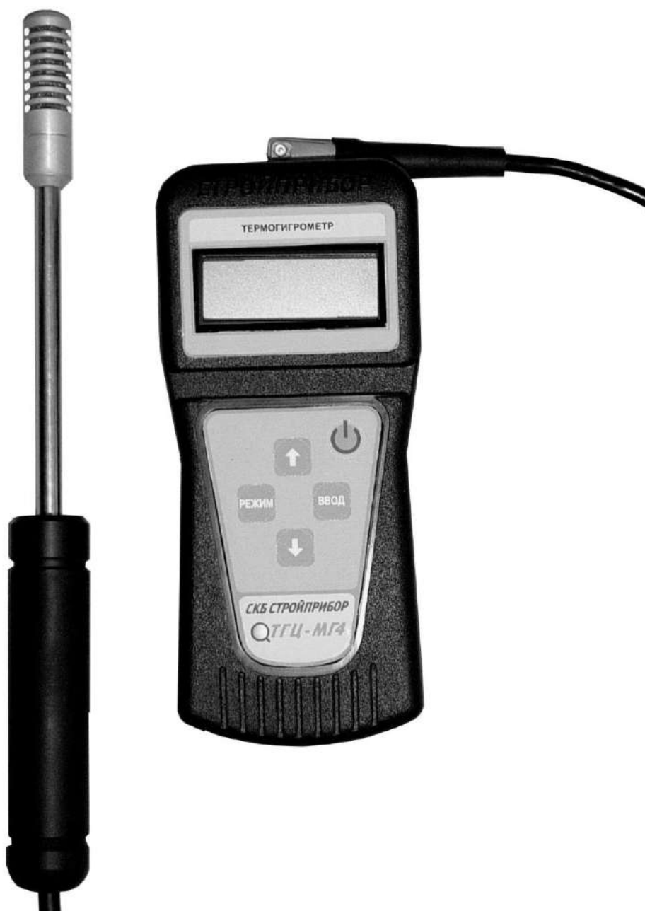
Рисунок 3.1 – Общий вид термогигрометра ТГЦ-МГ4 (ТГЦ-МГ4.01)
